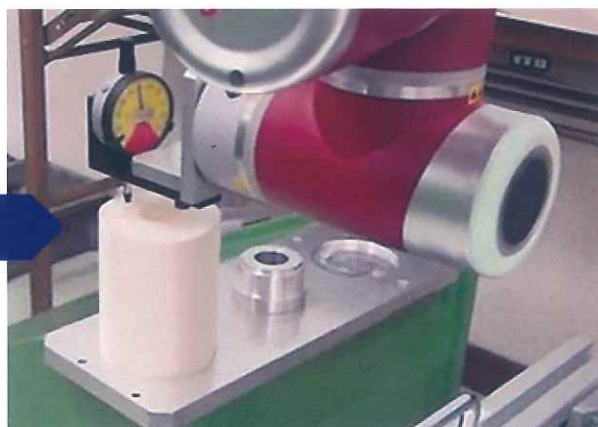
ロボットにダイヤルゲージや電気マイクロメーターを設置することで品質保証・検査等の測定業務が可能。
