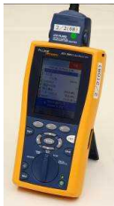
FLUKE DTX-1800 を用いた 測定・評価を行います
