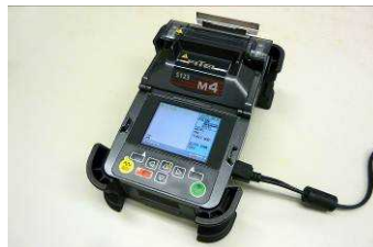
融着機(古河電気 S123M)を使用します。
